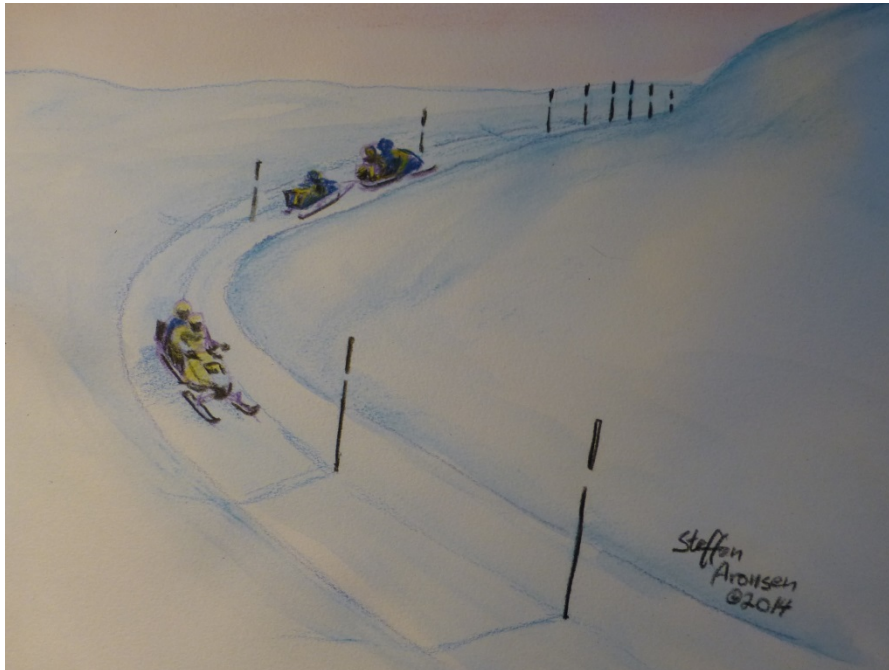
forsterket merking over bakketopp
